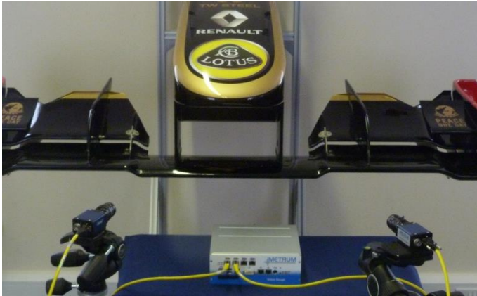
F1用車体の3次元変位計測の事例
